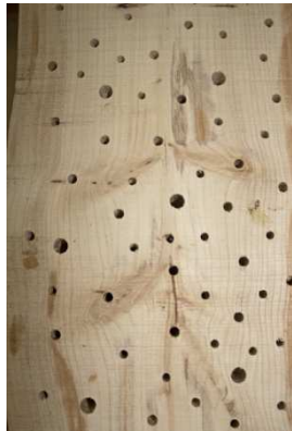
Abb. 2: Ausschnitt eines Holzblocks mit Bohrungen ins Längsholz.
